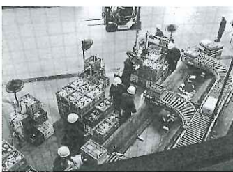
缶を選別するスタッフは空き缶に入ったばねを吸い取り、手で作業を確認する
